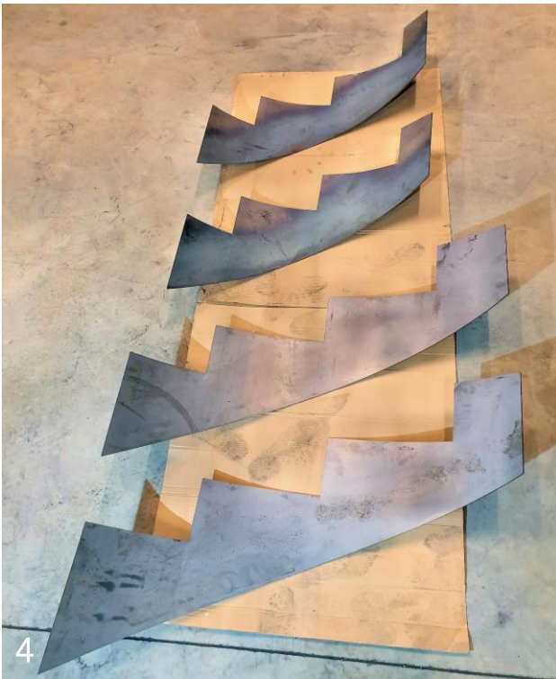
Exemple de réalisation 1 Conception | 2 Soudure | 3 Meulage | 4 Roulage | 5 Tôles découpées au laser | 6 Ouvrage complet
